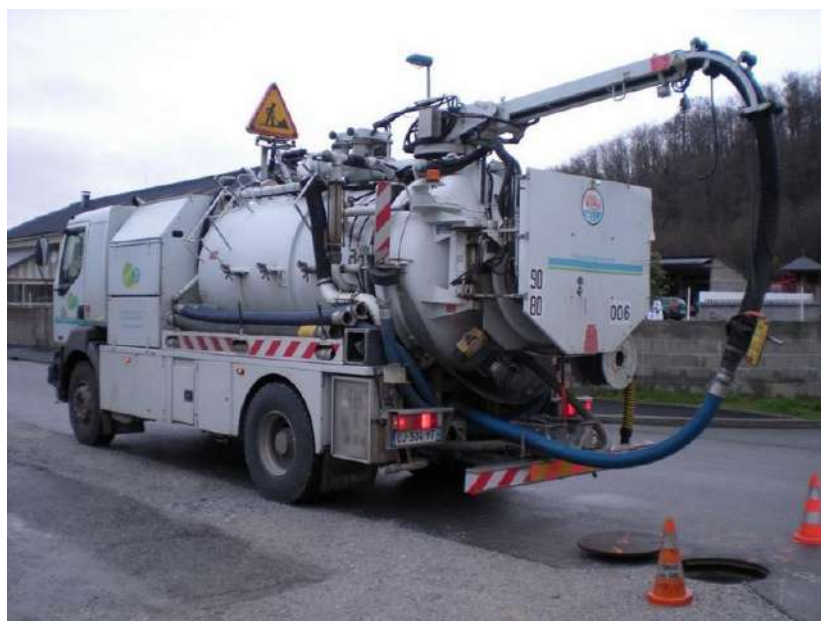
Graisses dans un regard de visite (Provenant d'effluents industriels bruts), non conformes à la collecte (non prétraités) à Bénéjacq / Camion d'hydrocurage en intervention d'urgence.
